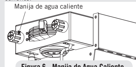
Figura 6 - Manija de Agua Caliente
